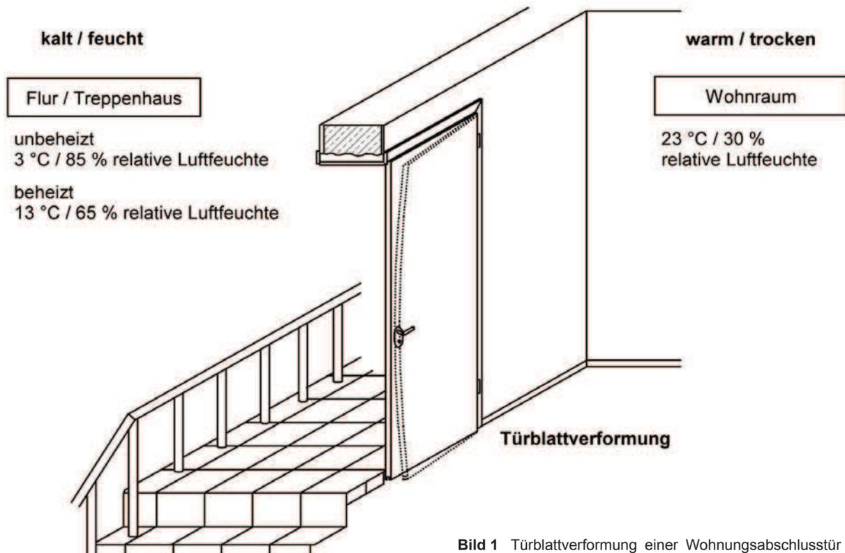
**Bild 1** Türblattverformung einer Wohnungsabschlusstür bei Differenzklimabeanspruchung
