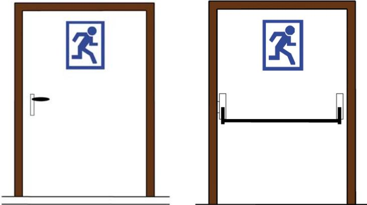
**Bild 2** Unterschied Notausgangs- (links) und Paniktürverschlüsse (rechts)
