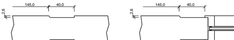
Maße gelten für gefälzte Elemente, bei stumpfen Elementen müssen seitlich und oben 13mm abgezogen werden
